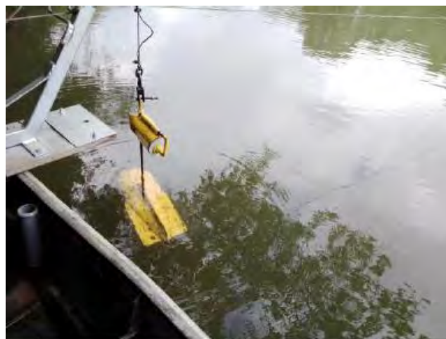
Foto 2 – Amostragem de sedimento em suspensão no PFM (Data: 16/05/2022).
