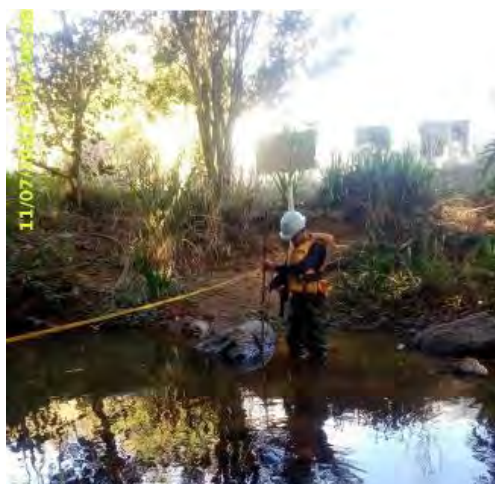
Foto 5 – Medição de descarga líquida no PSED. (Data: 11/07/2022).
