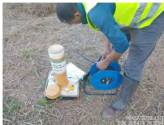
Foto 4 - Leitura de nível d'água no PM-BP-04. (Data: 18/07/2022).
