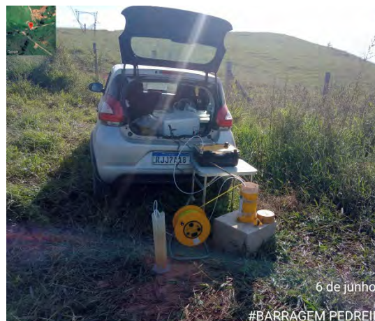
Foto 5. Foto com ênfase no processo de amostragem de água subterrânea no PM-09.
