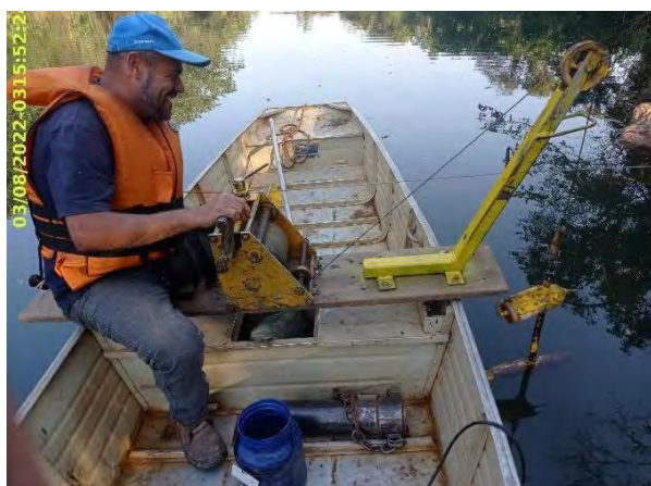
Foto 7 – Medição da descarga líquida no PHM. (Data: 03/08/2022).
