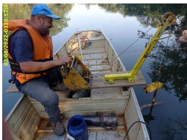
Foto 7 – Medição da descarga líquida no PHM. (Data: 03/08/2022).
