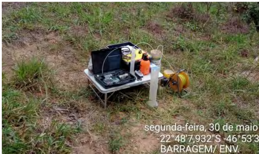
Foto 1 – Instrumentos utilizados para a realização da medição dos parâmetros físico-químicos “ in situ ”.
