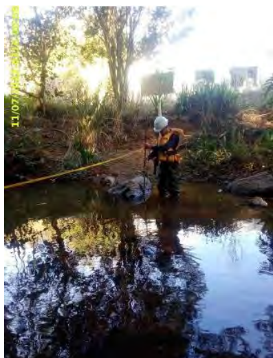
Foto 5 – Medição de descarga líquida no PSED. (Data: 11/07/2022).
