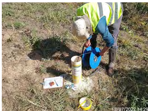
Foto 3 - Leitura de nível d'água no PM-BP-01. (Data: 18/07/2022).
