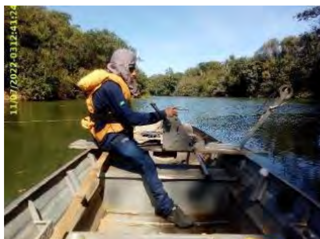
Foto 4 – Amostragem de Sedimento em suspensão no PHM. (Data: 11/07/2022).
