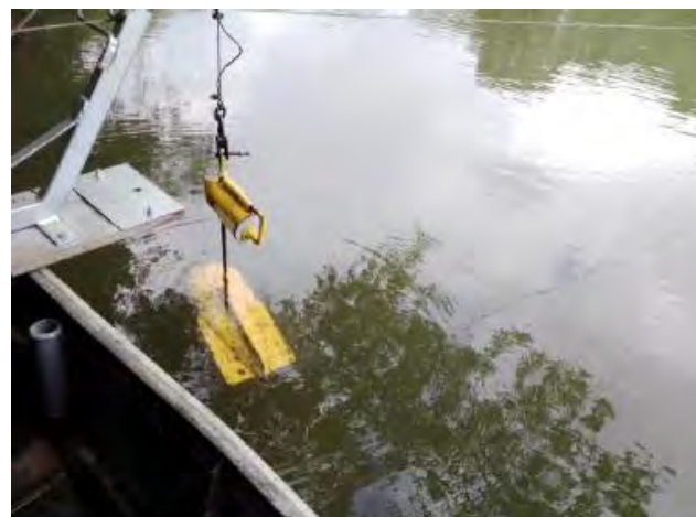
Foto 2 – Amostragem de sedimento em suspensão no PFM. (Data: 16/05/2022).
