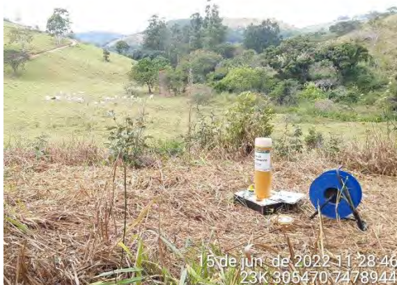
Foto 1 - Leitura de nível d'água no PM-BP-04. (Data: 15/06/2022).
