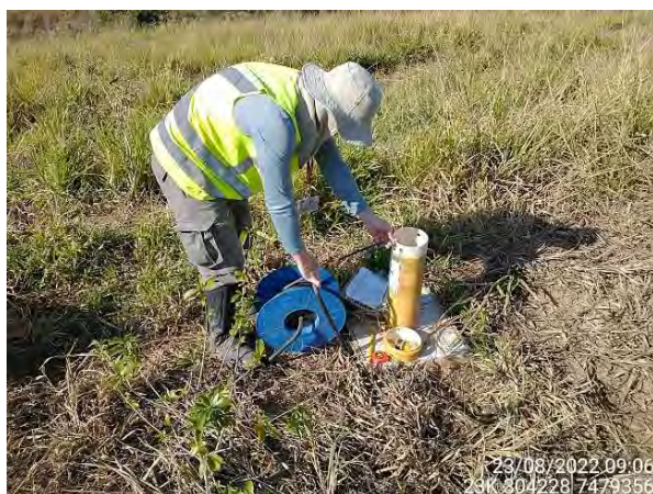
Foto 5 - Leitura de nível d'água no PM-BP-11. (Data: 23/08/2022).
