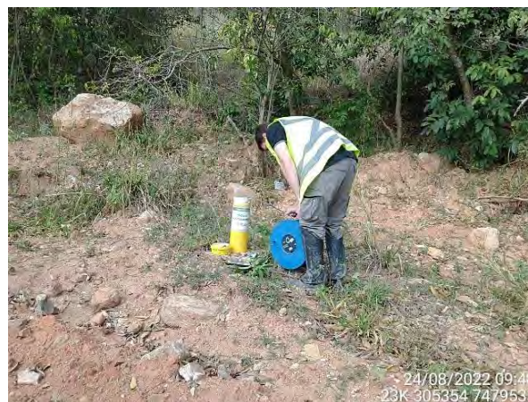
Foto 6 – Leitura de nível d'água no PM-BP-06. (Data: 24/08/2022).
