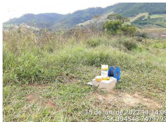
Foto 2 - Leitura de nível d'água no PM-BP-09. (Data: 15/06/2022).
