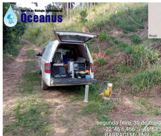
Foto 3. Foto com destaque para a amostragem do poço de monitoramento PM-07.
